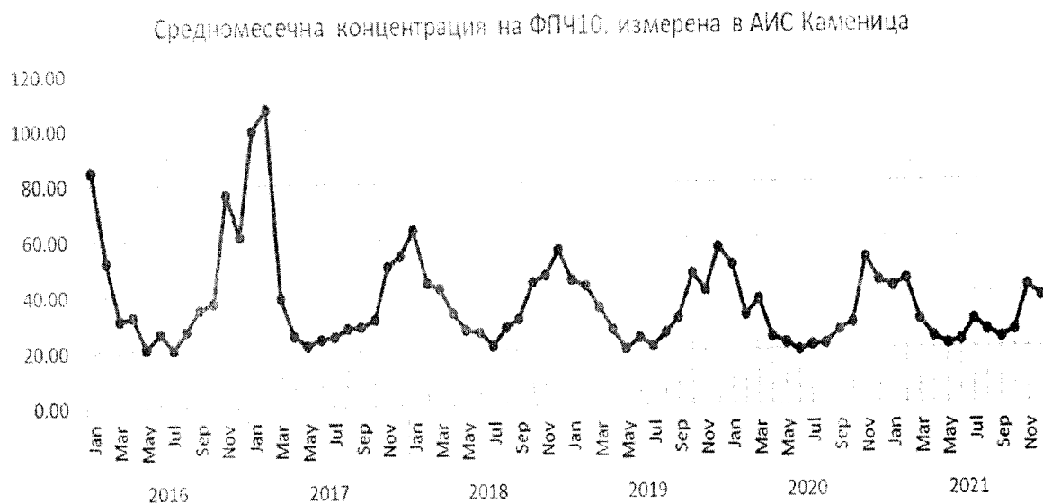
Фигура 6.3 Времени ред на средномесечните измерени стойности на концентрацията на ФПЧ 10 \mu\text{g}/\text{m}^3 в АИС „Каменица“
